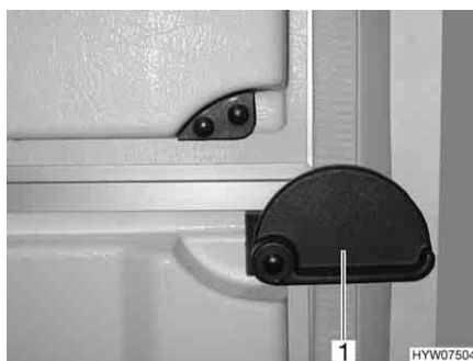
Fig. 25 Leva di serraggio sulla parte inferiore della porta
