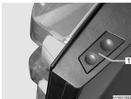
Fig. 151 Tasto di sblocco della porta del frigorifero (serie Dometic 8)
