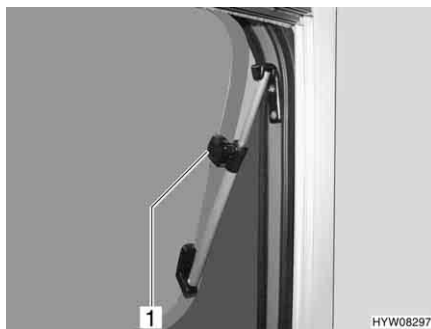
Fig. 18 Finestra apribile con deflettori a rotazione, aperta
