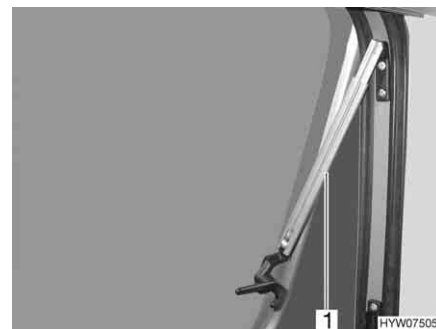
Fig. 19 Finestra apribile con deflettori automatici, aperta
