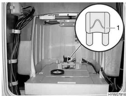
Fig. 65 Fusibile della toilette Thetford
