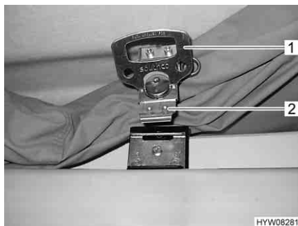
Fig. 24 Serratura rapida, aperta
