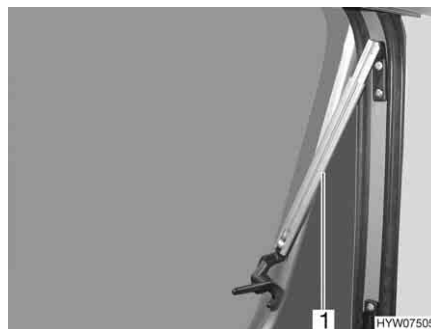
Fig. 14 Finestra apribile con deflettori automatici, aperta
