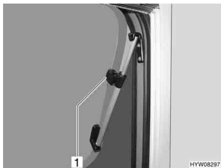
Fig. 13 Finestra apribile con deflettori a rotazione, aperta
