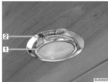
Fig. 136 Lampada alogena a incasso (piatta)
