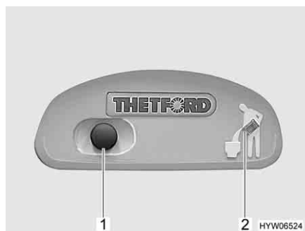
Fig. 221 Pulsante dello sciacquone/spia di controllo toilette Thetford
