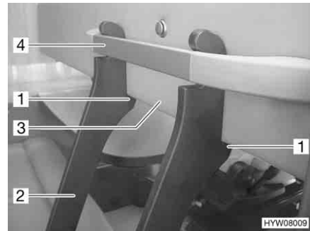
Fig. 101 Scaletta di accesso correttamente posizionata
