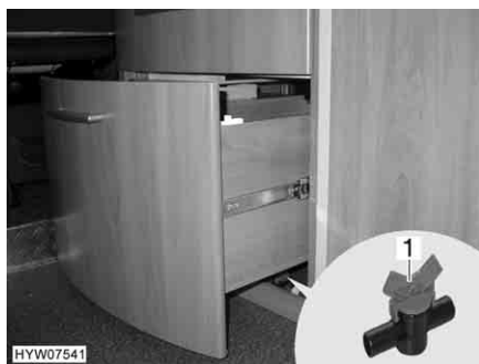
Fig. 218 Rubinetto di scarico sotto il piano di lavoro
