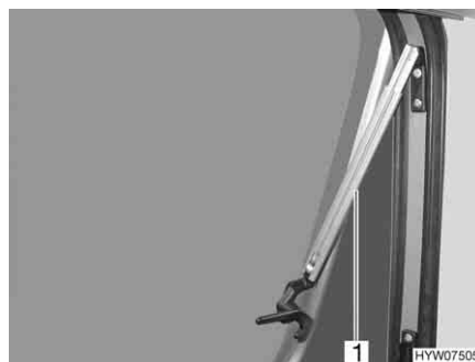
Fig. 22 Finestra apribile con deflettori automatici, aperta
