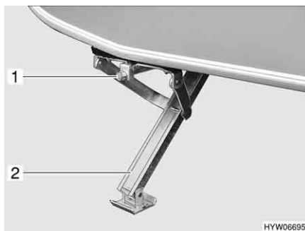
Fig. 8 Piedini di stazionamento a manovella abbassati
