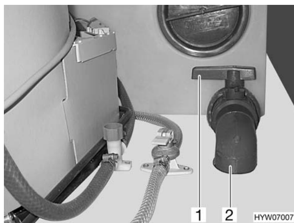
Fig. 81 Leva di comando e tubo di scarico del serbatoio delle acque grigie
