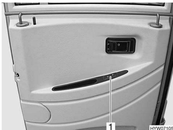
Fig. 19 Interruttore per l'alzacristalli elettrico nella porta guidatore
