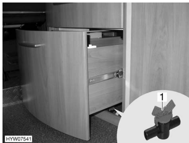
Fig. 181 Rubinetto di scarico sotto il piano di lavoro
