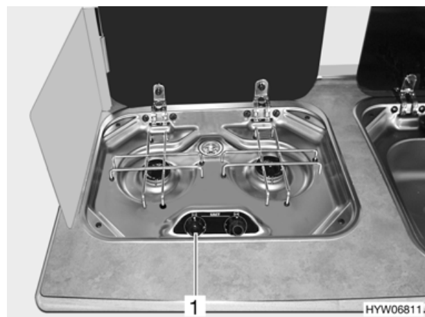
Fig. 79 Elementi di comando del fornello a gas
