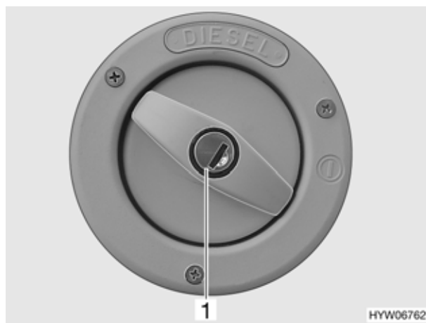
Fig. 15 Coperchio per bocchettone di riempimento per il rifornimento di carburante
