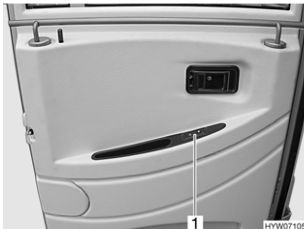
Fig. 19 Interruttore per l'alzacristalli elettrico nella porta guidatore
