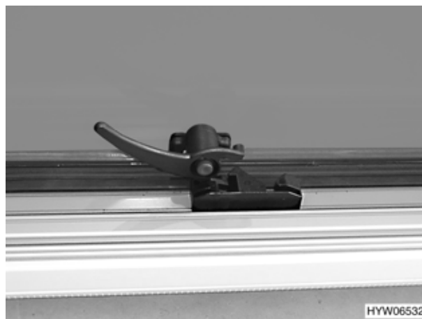
Fig. 44 Finestra apribile in posizione di "aerazione continua" (variante 2)
