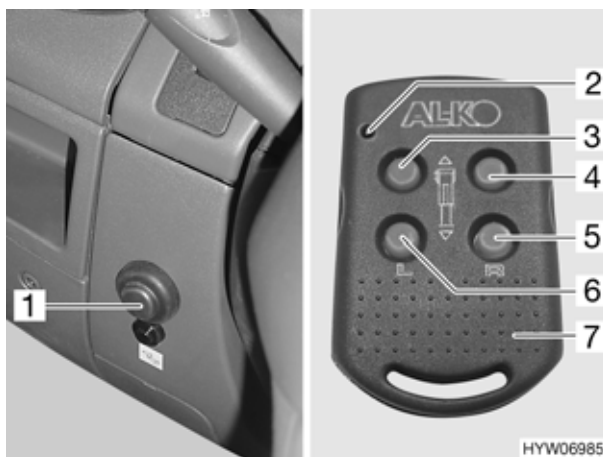
Fig. 23 Interruttore a pressione/telecomando per piedini di stazionamento elettrici
