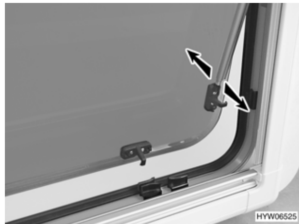
Fig. 42 Finestra apribile, guida telescopica (variante 2)
