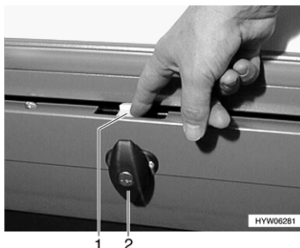
Fig. 35 Sicurezza della serratura gavone estraibile sottopavimento
