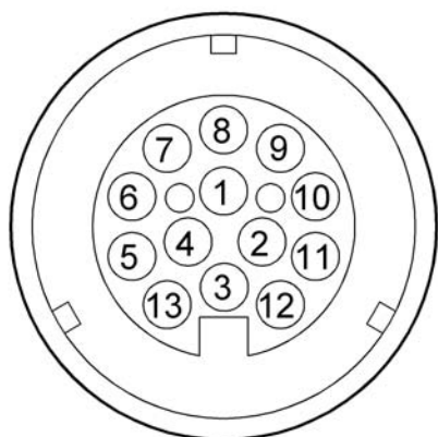
Bild 55 Kontaktbild des dreizehnpoligen Steckers
