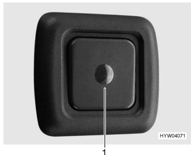
Bild 74 Bedienschalter für Boiler (Swing/Nova)
