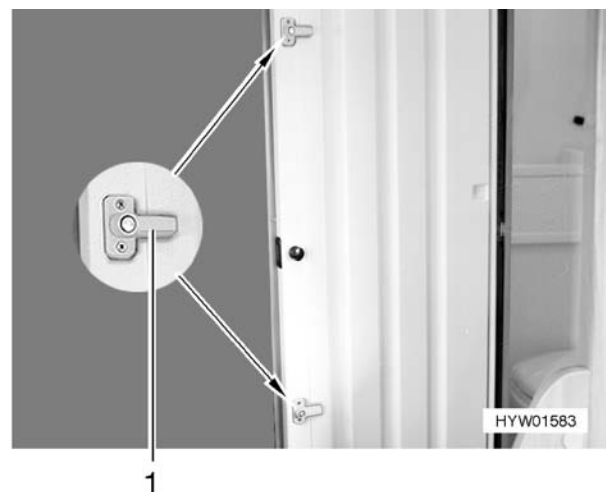
Fig. 106 Bagno Vario, porta del bagno, bloccaggio porta, parte interna
