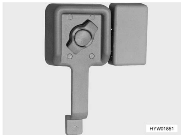
Fig. 13 Chiusura della serratura della porta di ingresso e della portiera lato guida, veduta interna
