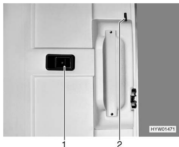
Fig. 16 Serratura della porta di ingresso, veduta interna
